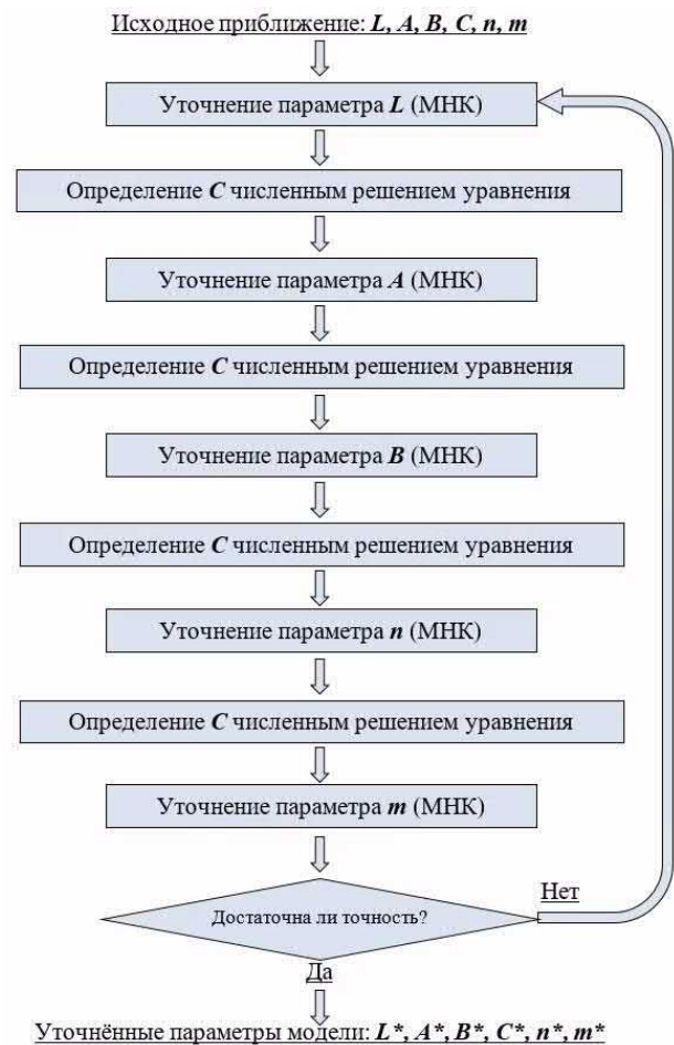
Рис. 5. Алгоритм вычисления параметров модели (9) по набору экспериментальных данных
